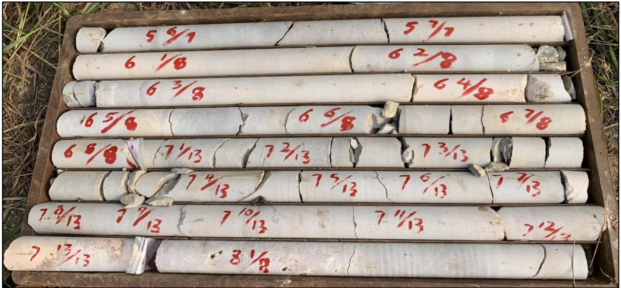
图3.3-2 ZK0304钻孔白云岩岩心照片（6.90-14.00m）
