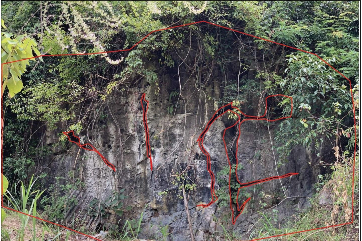
图 3.2-2 板洞矿区岩溶统计素描面 ( C_2h^3 , 生物碎屑灰岩, YRTJ-P3 红色为岩溶发育区)
