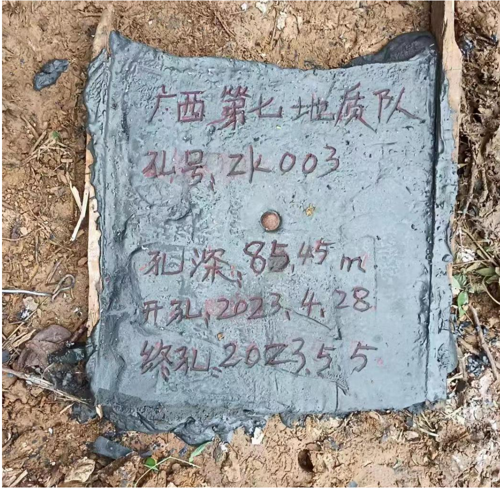
照片 3-6-2 钻孔封孔标志
