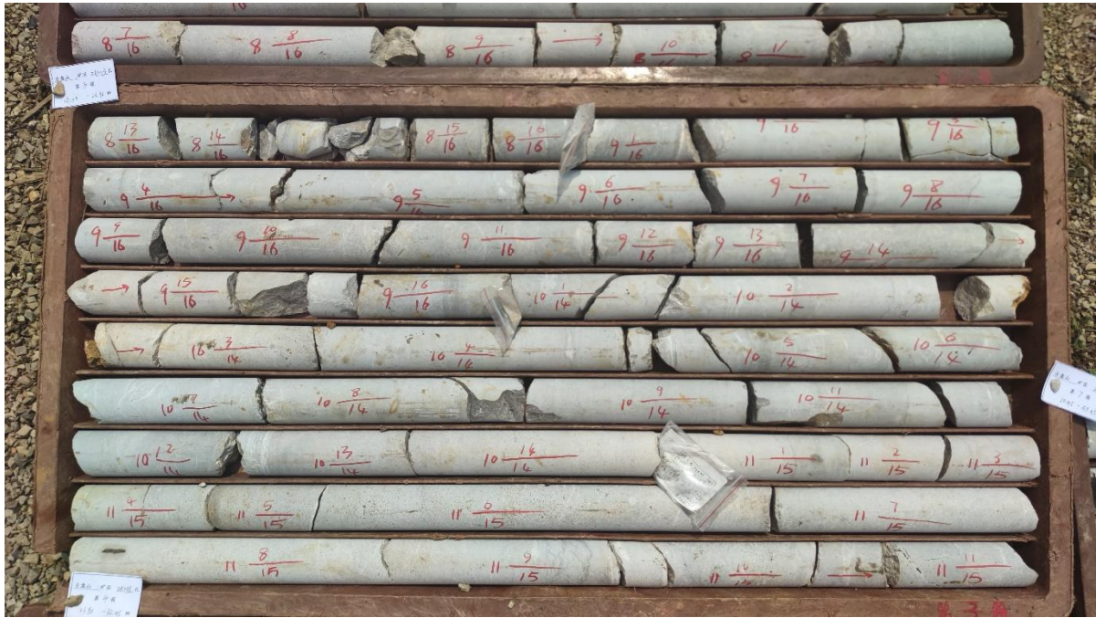
照片 3-6-1 ZK003 岩矿心采取情况
