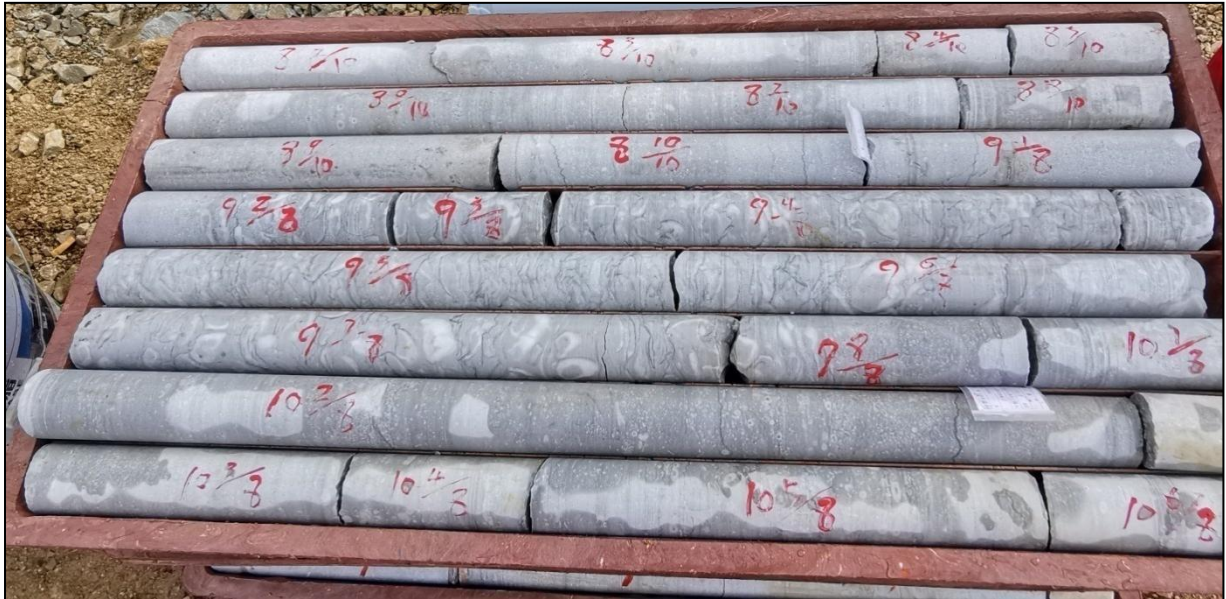
图 3-7 ZK001 11-18m 岩心照片（I号矿体，灰色深灰色生物碎屑白云质灰岩，含腕足化石（灰姑娘）、双壳类化石（金钱花））
