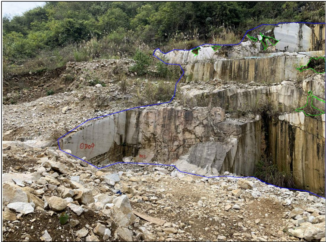
图 3-6 果排山饰面用灰岩矿II号矿体白云岩岩溶率统计素描面（绿色线为岩溶发育区，蓝色线为本次岩溶率统计范围）
