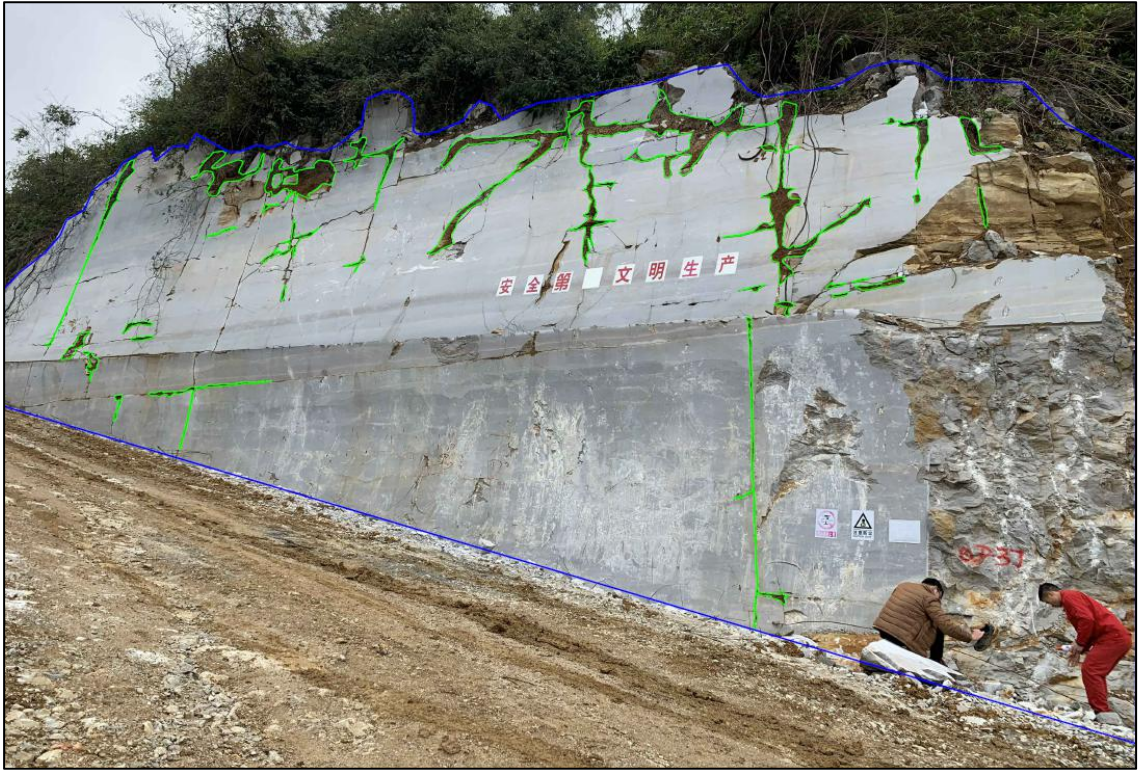
图 3-5 果排山饰面用灰岩矿I号矿体生物碎屑灰岩岩溶率统计素描面（绿色线为岩溶发育区，蓝色线为本次岩溶率统计范围）
