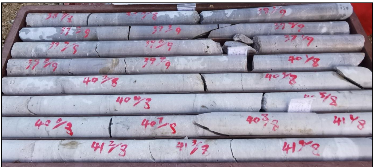
图 3-8 ZK001 103-111m 岩心照片（II号矿体，灰质白云岩或白云岩，“洞石”）
