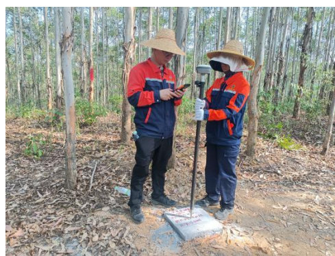
相片 3-24 钻孔孔口测量（RTK）
