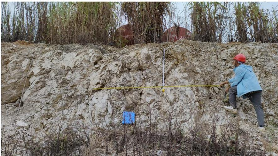
图 3-8 矿区地表溶隙
