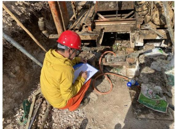
图 3-10 钻孔注水试验
