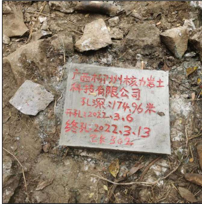
照片 3-6-3 钻孔 ZK302 封孔标志
